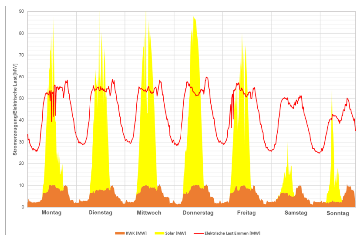
Abbildung 10: Stromerzeugung und Stromverbrauch für eine typische Woche im März – Emmen.
